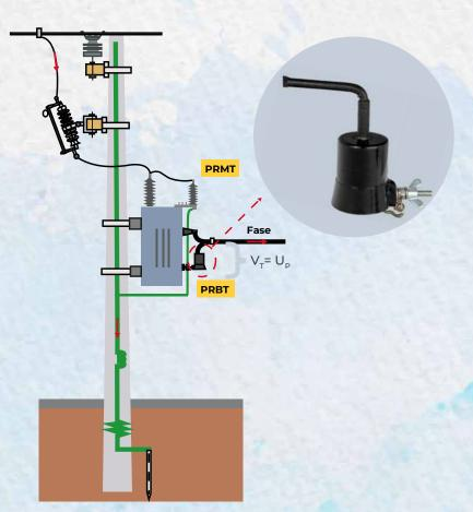
Para la debida protección al transformador, el PRBT CLAMPER debe instalarse en redes de baja tensión, en el secundario del transformador, conectado entre la fase y el conductor neutro, requiriendo un DPS para cada fase.
