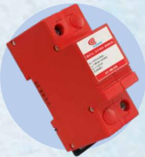
Dispositivo de protección contra sobretensiones de clase I (DPS), utilizado para proteger los equipos instalados en la entrada de los edificios de picos eléctricos originados por descargas atmosféricas, CLAMPER SCL es un DPS con alta capacidad de drenaje de corriente impulsiva (forma de onda de 10 / 350 $\mu$ s) y alto soporte para la corriente de corto circuito. Cuenta con la tecnología Spark Gap (CSG), compuesta por Air Spark.
